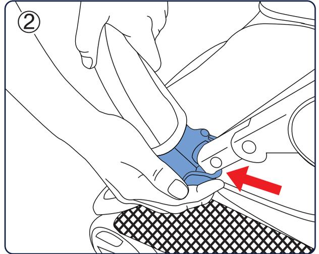
1. ①번의 그림처럼 안전가드 양 끝의 안전가드 분리 장치를 (A) 화살표 방향으로 밀어내어 좌·우 모두 열어준 후 안전가드를 앞으로 당겨 분리합니다.
