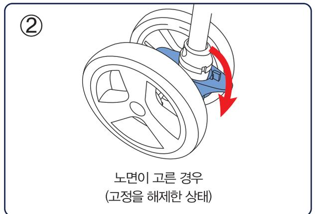
1. ①번의 그림처럼 앞바퀴 고정레버를 흠에 맞게 위로 올리면 앞바퀴의 방향 전환이 고정되고, ②번의 그림처럼 아래로 내리면 고정된 앞바퀴의 방향 전환이 해제됩니다. 노면이 고르지 못한 길에서 고정하여 사용하시면 주행능력이 향상됩니다.
